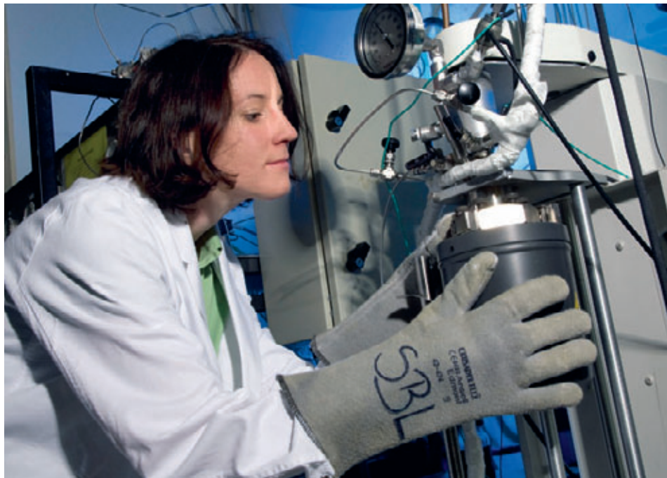
Auf dem Prüfstand: Mit der Anlage testet die Chemikerin, wie viel Methanol pro Stunde produziert werden kann. Handschuhe sind Pflicht: Die Reaktion läuft bei 150 bis 200 Grad Celsius ab.
