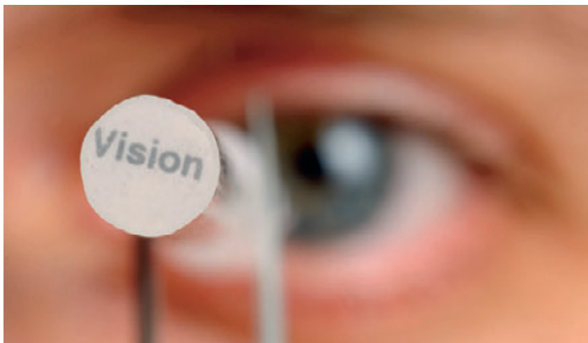
Das Röhrchen besteht wie die Netzhaut aus optischen Fasern. Der Schriftzug „Vision“ wird mit minimalem Verlust von der einen zur gegenüberliegenden Oberfläche transportiert.
